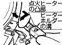
6 片手でヒーターholdderをつまみ、新しい点火ヒーターの凸部をヒーターholdderの溝を通すように入れたら、押しつけながら回して、点火ヒーターの凸部を、ヒーターholdderの凹部にはめ込んでください。
